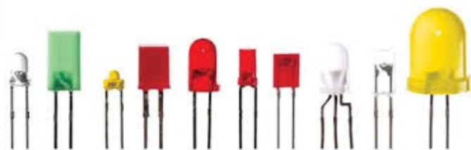
Figura 1. LEDs encapsulados com resina de cristal.
